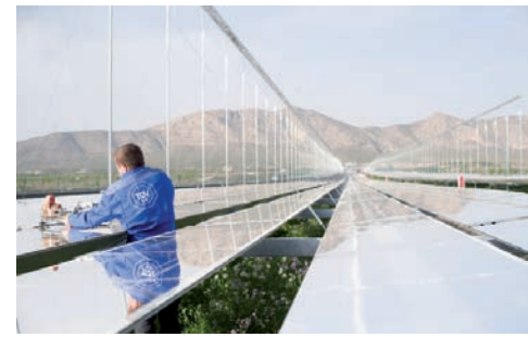
Ensayo de los espejos planos: El alto nivel de fiabilidad de regulación y de posicionamiento de los espejos planos es crucial para una operación eficiente de la planta.
